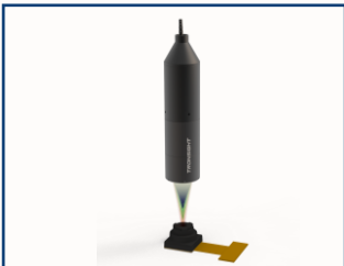
测量手机相机模块的行程
