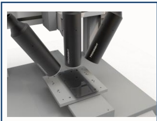
测量手机相机模块的行程
