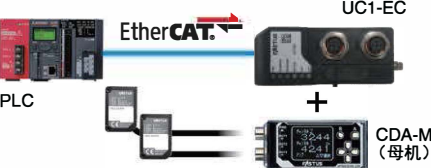
TS-S22连接CDA+UC1 仅连接1台CDA使用时
