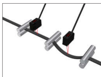
检测橡胶带的拉紧·下垂程度
